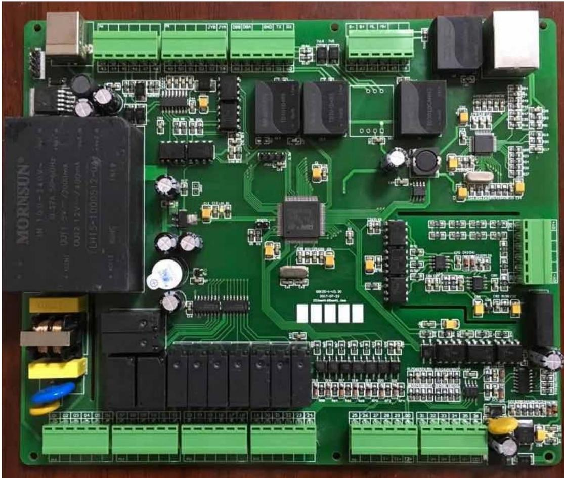
如上两组图示 QGKZD-1 为直流充电桩核心控制板，控制单枪，可以满足直流单充充电桩的控制。具体功能配置如下：
